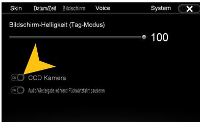
Aktivieren Sie unter „CCD Kamera“ die optional an das Gerät angeschlossene Rückfahrkamera. Sobald der Rückwärtsgang eingelegt wird, wird die Video-Übertragung der Kamera automatisch auf dem Bildschirm einblendend.
