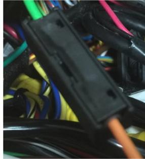
Nun muss das andere Ende des orangenen Lichtleiterkabels an das Dension Gateway an den „Car Side“-Anschluss, hier im Bild links, an die rechte Position dieses Steckers angeschlossen werden. Verwenden sie den mitgelieferten Plastikeinsatz dafür. Die linke Position wird mit dem mitgelieferten orangenen Lichtleiter mit der freigewordenen Stelle am Radio-Quadlockstecker verbunden.
