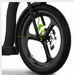
Freno a disco anteriore e posteriore
