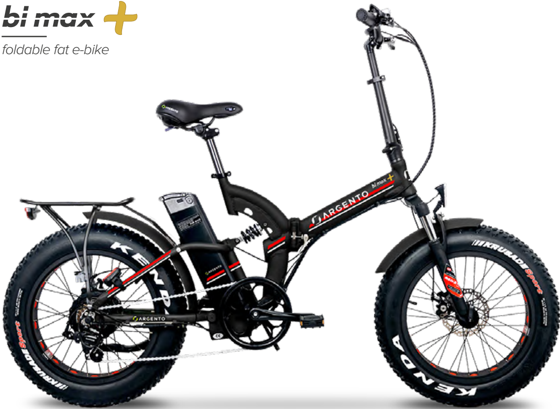
Battery Samsung da 36V 10.4Ah
