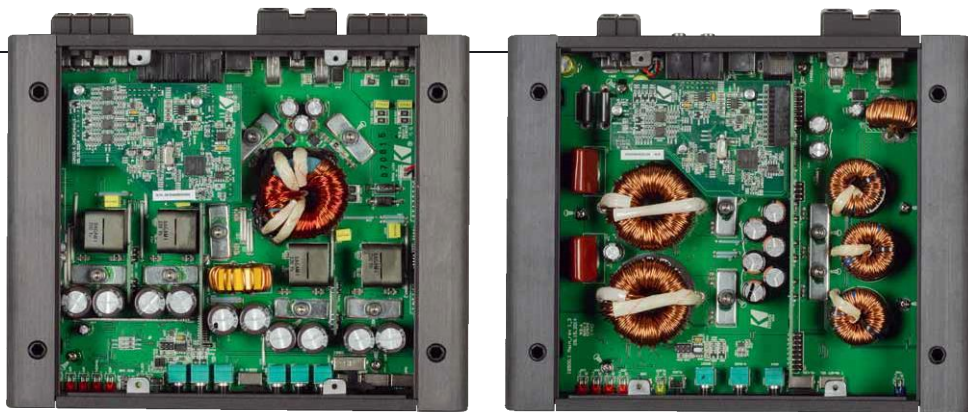
IQ500.4 (links) und IQ500.1 sind moderne Class-D-Verstärker mit DSP-Tochterplatinen (oben links/Mitte)
