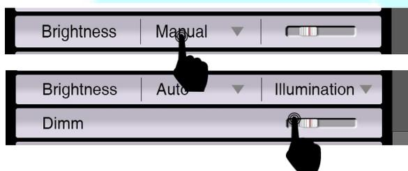
Betätigen Sie mit einem kurzen Druck auf den Schieberegler den Einstellungsregler für die Dimmfunktion.
